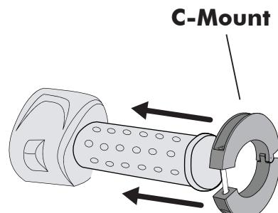
**I** Stringere il kit di fissaggio all'interno del coprimanopola R363X come in figura. **ATTENZIONE: non stringere troppo il kit per non bloccare il ritorno libero dell'acceleratore.**
