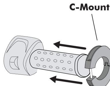
Serrer le kit de fixation à l'intérieur du couvre-poignée R363X comme dans l'illustration. ATTENTION : ne pas serrer excessivement le kit pour ne pas bloquer le retour libre de l'accélérateur.
